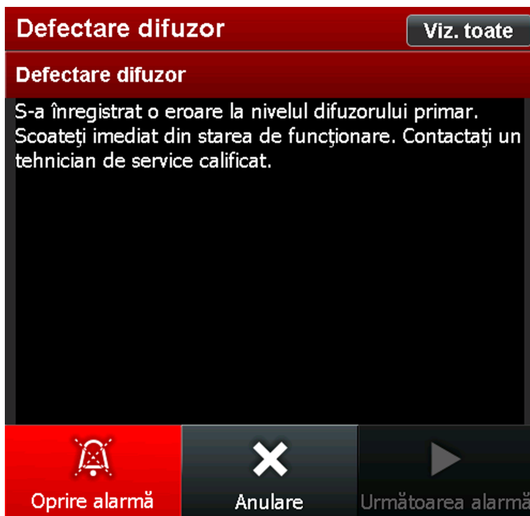
Figura 8-4. Exemple de mesaje de defectare a difuzorului
